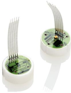
**Capteurs piézorésistifs :** les puces semi-conductrices des capteurs piézorésistifs ont un niveau de signal beaucoup plus élevé que les résistances des capteurs à couche mince et à couche épaisse. C'est pourquoi les capteurs piézorésistifs atteignent une plus grande précision avec un calibrage correct. Ils sont cependant plus sensibles aux températures élevées, et donc plus susceptibles à la dérive de signal, notamment dans les environnements chauds. Cela affecte leur stabilité à long terme.
